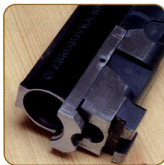
Деталь экстрактора в нарезном стволе. Крючок маленький, но работает надёжно
